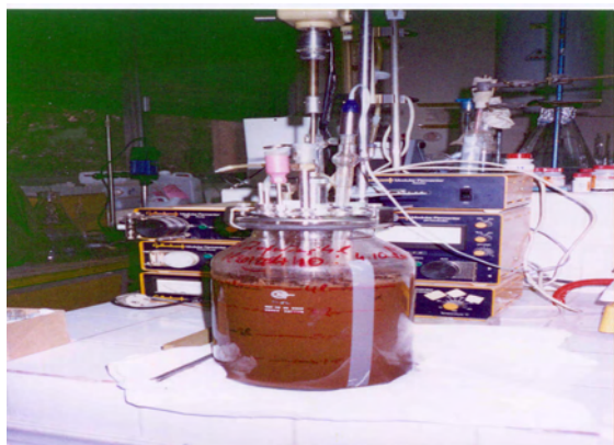
Εικόνα 3. Ζύμωση αποβλήτων ελαιουργείου με το μύκητα Pleurotus ostreatus
