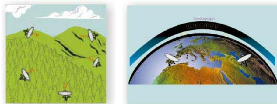
Εικόνα 13. Μετάδοση (α) επιφανειακών κυμάτων και (β) κυμάτων χώρου
