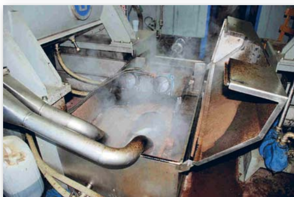
Φωτογραφία 13. Τύποι φυγοκεντρωτών, όπου διαχωρίζονται λάδι-νερό και στερεά κατάλοιπα.
